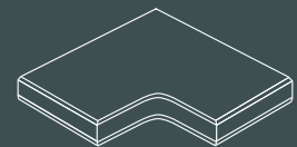
| AF 50/GetaCore® | one piece corner top L-form 900 x 900 x 610 x 49 mm
